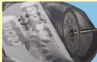
Благодаря алмазному напылению краев изъятие заготовки из рамки более безопасно.
