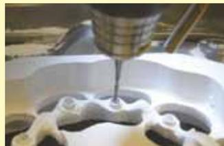
Глубокие фрезерованные отверстия как абатменты беспрепятственно получают с помощью длинных форм.
