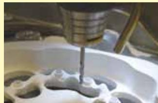
Фрезы для абатментов благодаря прямоугольной форме на участке головки обеспечивают припасовку платформы имплантата.
