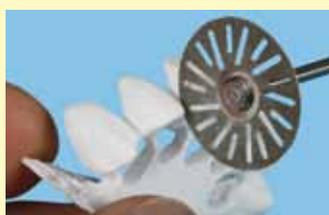
Наглядное разделение предварительно спекаемого циркония. Transflex посредством прорезей обеспечивает необходимую прозрачность, что способствует точной обработке.
