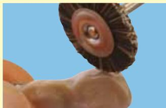
Незначительное давление и низкое число оборотов обеспечивают щадящую и экономную полировку.
