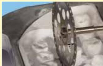
Отделение цирконовой конструкции от заготовки без перекося. Это повышает безопасность в процессе работы.
